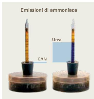
Figura 6: il kit per misurare la volatilizzazione dell'ammoniaca di Yara indica le emissioni, passando dal giallo al blu quando l'indicatore viene a contatto con l'ammoniaca emessa dal fertilizzante.
